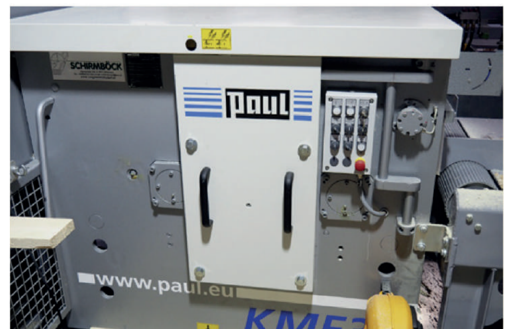
Die Besäumkreissäge KME3 von Paul in Linksausführung mit 800 mm Durchgangsbreite und einer maximalen Schnitthöhe von 125 mm
