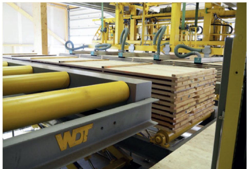
... und im Anschluss je nach Qualität mittels Vakuumroboter auf einen der Stapel abgelegt
